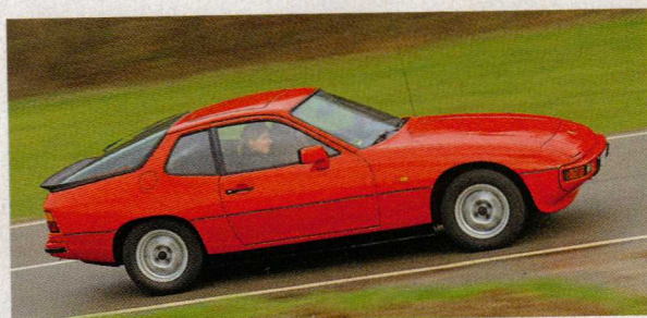
Mit dem Porsche 924 begann 1976 die Laufbahn der Transaxle-Vierzylinder aus Zuffenhausen: Saugmotor mit 136 PS
